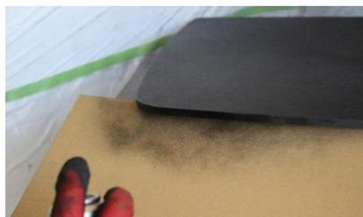
補修部分以外は塗料の飛散防止のため、極力養生をします。
