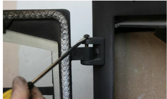
指で外せない場合は、写真(上)のようにマイナスドライバーで押し上げます。
