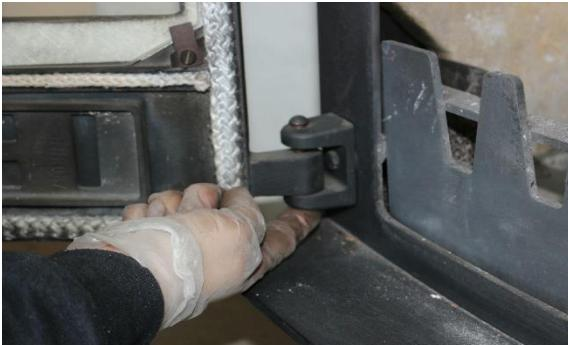
ヒンジの下からピンを指で押し上げて、ピンを外します。
